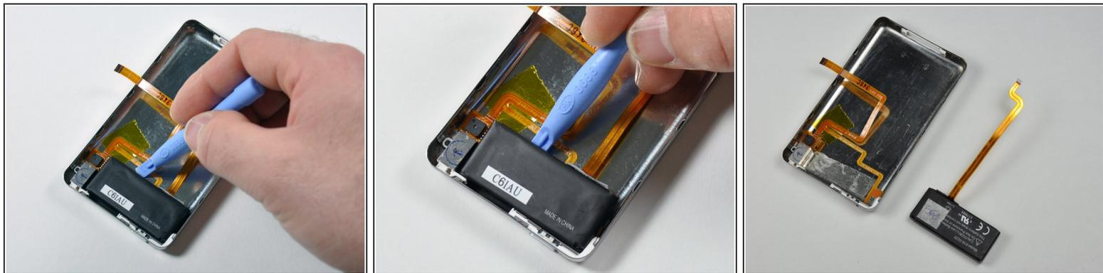
**⚠** Achte darauf, dass du während dieses Schritts keine der Kabel des Kopfhörers oder der Akku-Flachbandkabel beschädigst.
