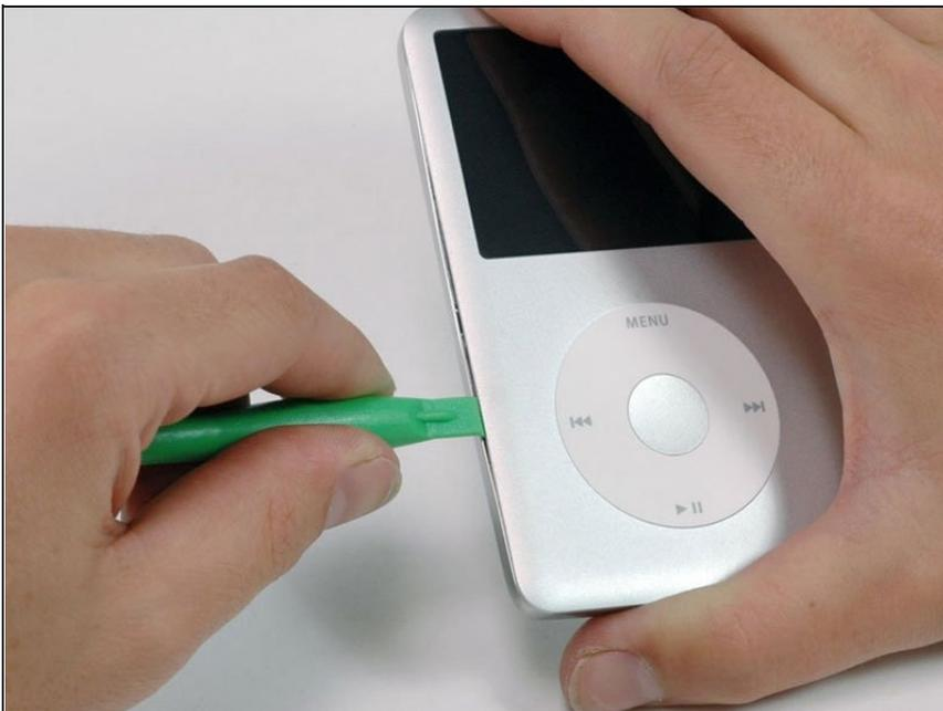
ⓘ Das Öffnen dieses iPod ist eine Herausforderung. Lasse dich nicht entmutigen, wenn du einige Versuche brauchst, bevor der iPod offen ist. Eine Sache, die du beachten musst, ist der Winkel der Spitze des Plastiköffnungswerkzeugs beim Einsetzen in den iPod. Im Idealfall sollte der Winkel so vertikal wie möglich sein.
