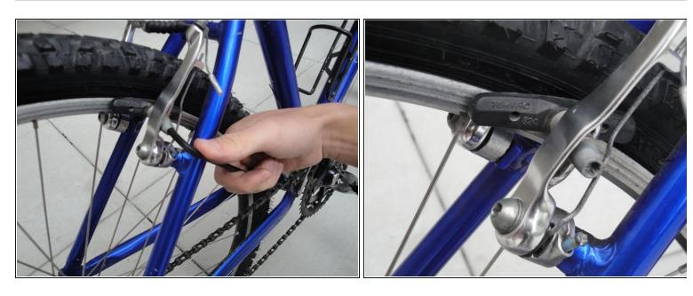
Loosen the brake pad bolt.
