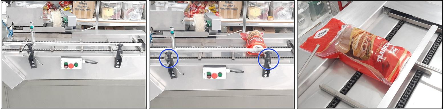
**i** O próximo passo é ajustar a **Plataforma de apoio lateral**.
