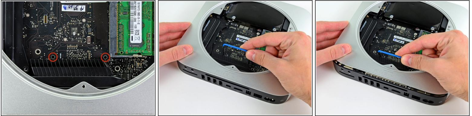
**⚠** ロジックボードを取り外すには、Mac mini Logic Board Removal Tool の2本の筒型の棒を赤でハイライトされた穴に挿入しなければなりません。それ以外の基板上の穴に工具を入れると故障を招く事があります。
