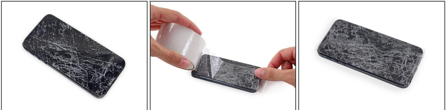
**i** Se o vidro de seu visor estiver rachado, mantenha as rachaduras sob controle e evite danos corporais durante o reparo cobrindo o vidro com fita adesiva.
